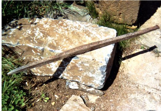
Der Strahlstock ist das Hauptwerkzeug des Strahlers.
